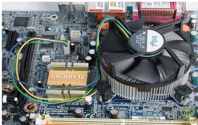
Hình 2.11: Gắn quạt hoàn thành
