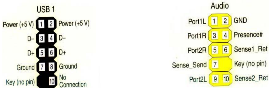
Hình 2.24: Sơ đồ gắn dây tín hiệu USB và Audio
