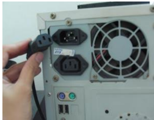
Hình 2.26: Buộc cố định các dây cáp và gắn dây nguồn điện
