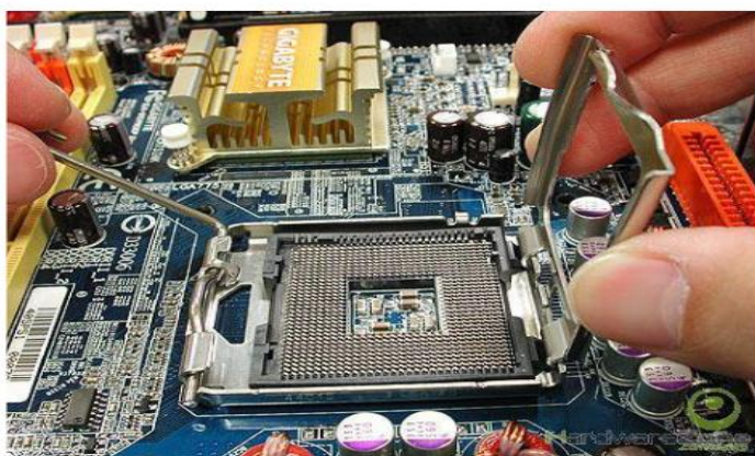
Hình 2.3: Để cắm CPU socket 775
