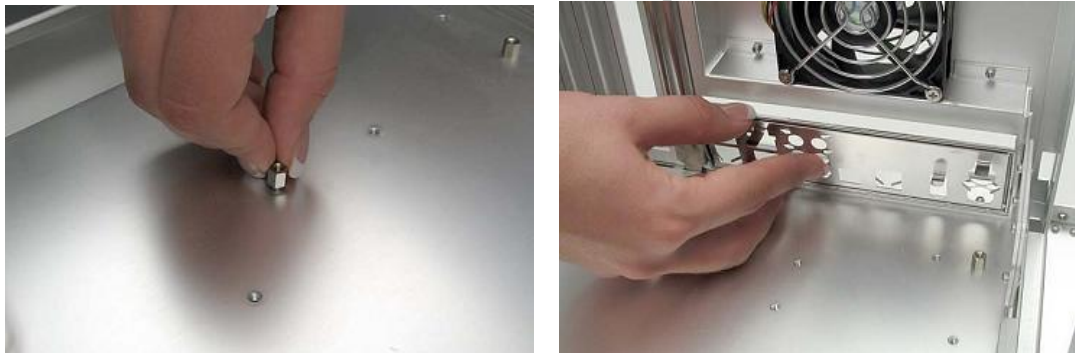
Hình 2.14: Bắt vít định vị trên Main và gắn nắp I/O với thiết bị ngoại vi
