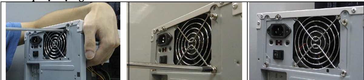
Hình 2.15: Đưa Main vào vỏ máy và vận vít cố định Main
